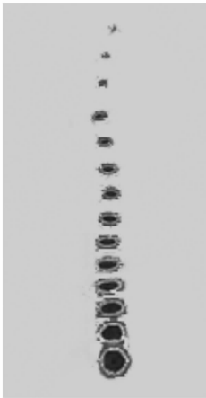
图 2 \text{NH}_3 鼓泡吸收过程的气泡运动轨迹 (气泡初始半径为 5 mm)
